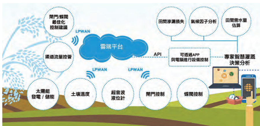
▲ 圖4 智慧灌溉系統架構
