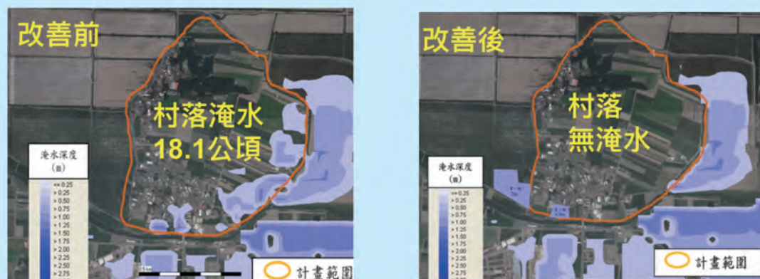
▲ 圖7 在地滯洪實施前後淹水模擬(採10年重現期距 24小時降雨)
