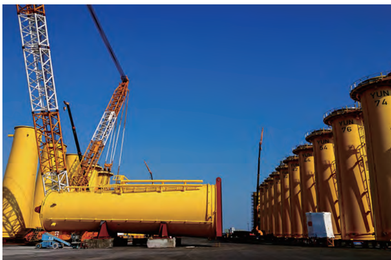
▲ 中鼎積極投入綠電領域，所承攬的雲林允能風場水下基礎轉接段於2020年成功交貨，開創首批國產離岸風機設備製造里程碑。
